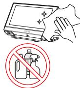
Der berührungsempfindliche Bildschirm wird zur Steuerung häufig genutzt. Dies kann Verschmutzungen hinterlassen, die für einen zuverlässigen Betrieb in regelmäßigen Abständen entfernt werden sollten. Eine behutsame Reinigung darf nur im stromlosen Zustand erfolgen.
