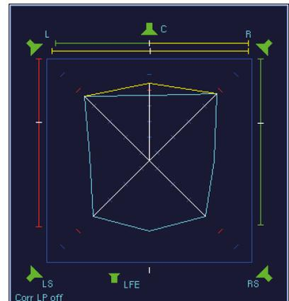
6 | Die ausgeklickte TVI-Linie zwischen LS und RS, keine Ausdehnung der PSI-Linie und Korrelation  $r = +1$  in der unteren Korrelationsgradanzeige deuten auf ein identisches Mono-Signal in beiden Surroundkanälen hin.
