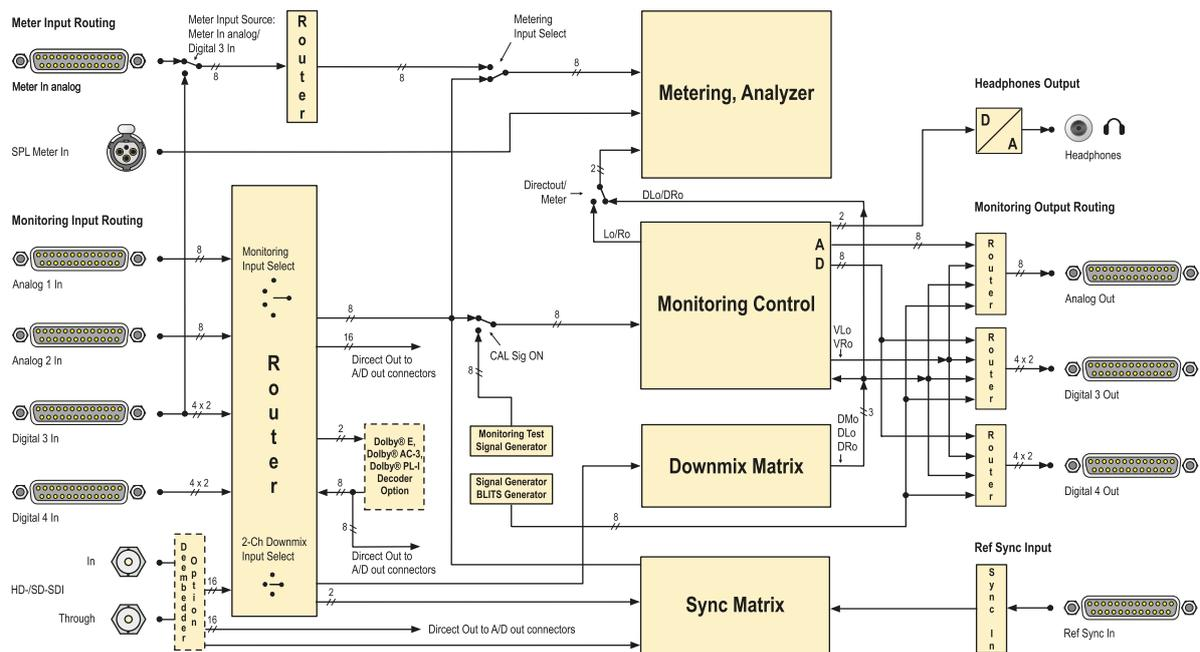
Das Gerät arbeitet intern mit logischen Kanälen (L, R, etc.), die dem jeweils gewählten Kanalformat entsprechen. So stehen beispielsweise bei 5.1 Surround als dem gewählten Kanalformat die internen logischen Kanäle L, R, C, LS, RS, LFE, Lext, Rext, Lo und Ro zur Verfügung. Die Zuordnung der physikalischen Signaleingänge zu diesen internen logischen Kanälen erfolgt im Input Routing für jeden Eingang separat.
