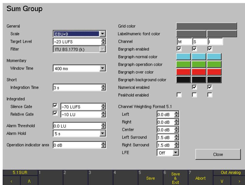
Die **Sum Group**, die rechts neben der **Channel Group** im **Program Meter** in Fenster 2 angeordnet ist, enthält bis zu drei Bargraphen zur Anzeige der summierten **Loudness** aller Einzelkanäle der Kanalgruppe:
