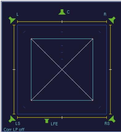
1 | Inkohärentes Rauschen mit gleichen Pegeln in den Kanälen L, R, LS und RS, ausgesteuert auf Referenzabhörschalldruckpegel. Die Korrelation ist jeweils  $r = 0$ , Phantomschallquellen sind nicht ortbar.
