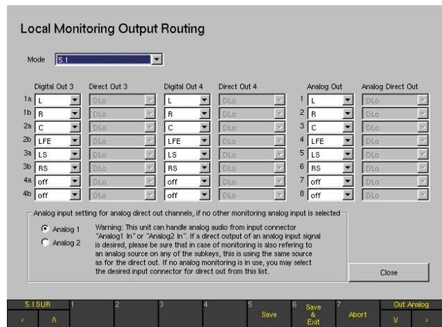
8. Verwenden Sie das Kombinationsfeld **Source**, um die gewünschte Eingangsbuchse des Geräts einzustellen. Verwenden Sie die darunter liegenden Kombinationsfelder (die z. B. im 5.1-Surround-Modus mit **L, R, C, LFE, LS, RS** beschriftet sind), um jedem dieser internen Kanäle den gewünschten Kanal der gewählten Eingangsbuchse zuzuordnen.
