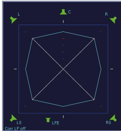
2 | Identisches Sinus-Signal mit gleichen Pegeln in den Kanälen L, R, LS, RS. Die Korrelation ist jeweils  $r = +1$  (ausgeklickte TVI-Linien), Phantomschallquellen (PSI) genau mittig, ähnlich einem Mono-Signal.
