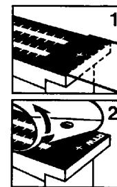
Klebefolie mitsamt der horizontalen Skala an einer Ecke vorsichtig anheben und flach in Pfeilrichtung abziehen. (Skizze 2)
