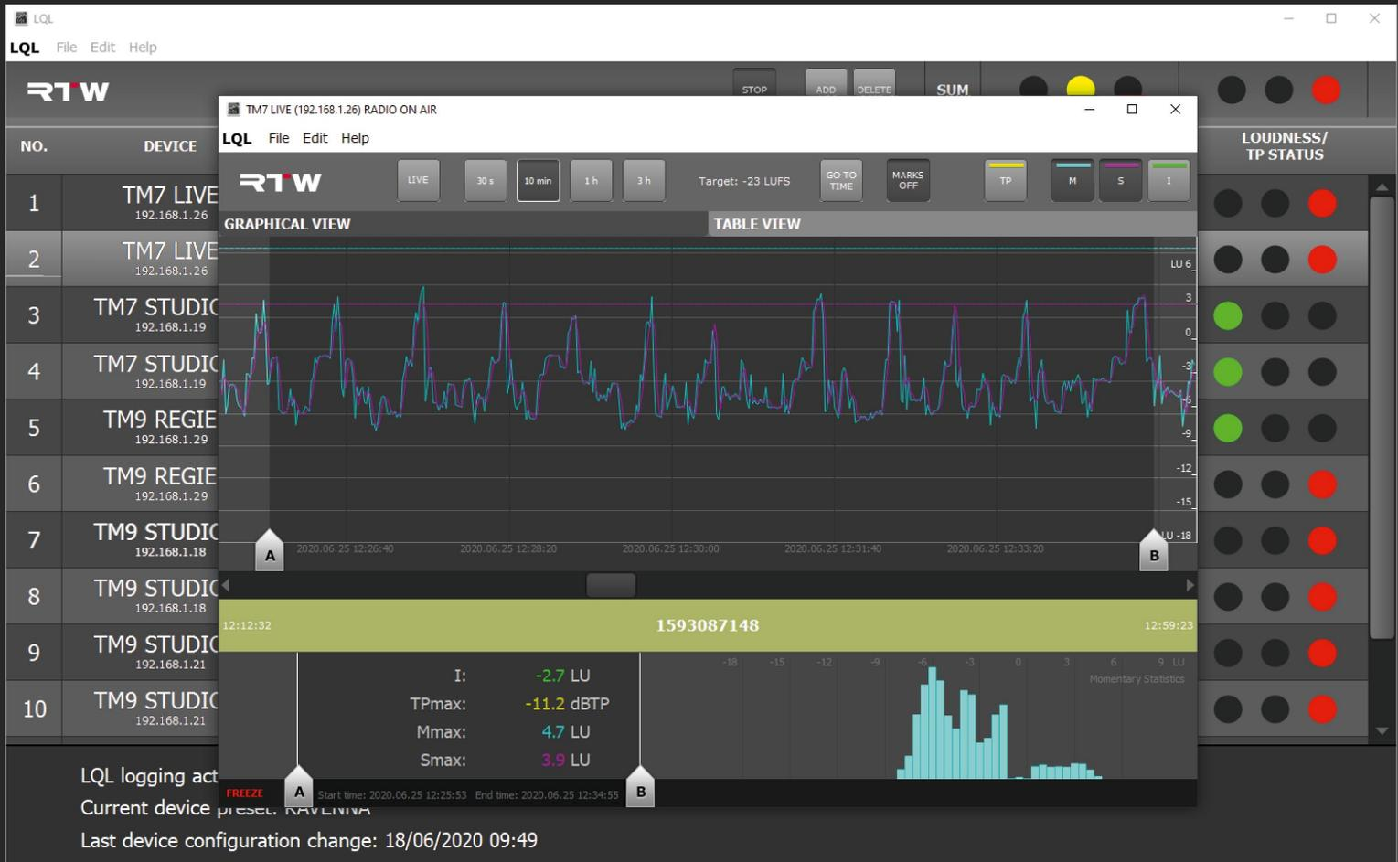
Mit dem **LQL – Loudness-Quality-Logger** bietet RTW eine Logging-Konsole, mit der Daten aus verschiedenen TouchMonitor-Geräten mit Loudness- und Logging-Data-Server-Lizenz direkt über eine IP-Verbindung oder von externen USB-Speichermedien abgerufen werden können und die eine unabhängige Speichermöglichkeit mit zusätzlichen Eigenschaften bietet.
