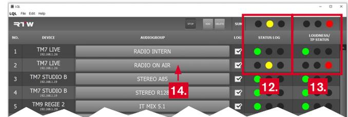
14. Klicken Sie im Bereich **AUDIOGROUP** auf die Schaltfläche mit dem Namen der Audio-Gruppe, deren **LOUDNESS/TP STATUS**-Anzeige mit **rot** signalisiert hat, dass es Verstöße gibt. Das Detail-Fenster für diese Audio-Gruppe wird geöffnet.
