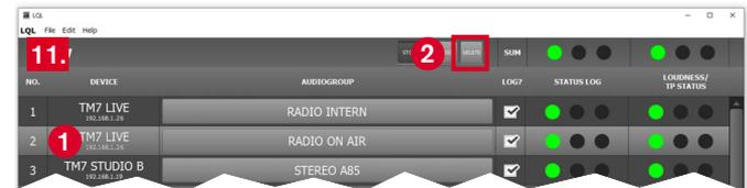
12. Beachten Sie die Spalte **STATUS LOG**. Die Ampel signalisiert, ob die Netzwerkverbindung einwandfrei (■), kurzzeitig gestört (■) oder unterbrochen (■) ist. Überprüfen Sie bei Störungen oder Unterbrechungen die Netzwerkverbindung.
