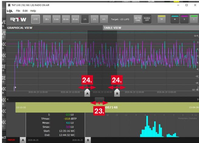
24. Halten Sie die linke Maustaste auf den Marken gedrückt und positionieren Sie sie um den Bereich, den Sie auswerten möchten. Der LQL führt beim Verschieben der Marken zeitnah unter Anzeige der markierten Start- und der Endzeit eine Neuberechnung durch. Die angezeigten numerischen Werte werden aktualisiert.
