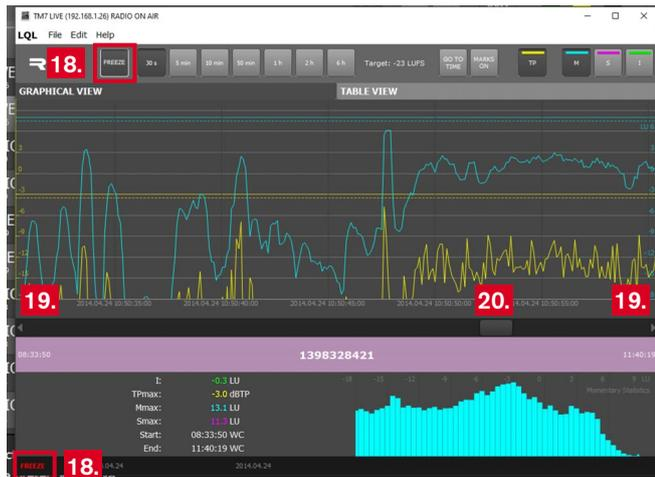
19. Verwenden Sie die Pfeiltasten links und rechts unterhalb des Graphen, wenn Sie in Schritten entsprechend der gewählten Zoom-Stufe navigieren möchten.
