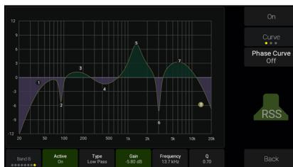
Jeder Lautsprecher verfügt über eine DSP-Sektion zur Kontrolle. Verzögerung, Verstärkung und Phase lassen sich individuell einstellen, ein 8-Band-EQ ist für jeden Lautsprecher in jedem Setup verfügbar.
