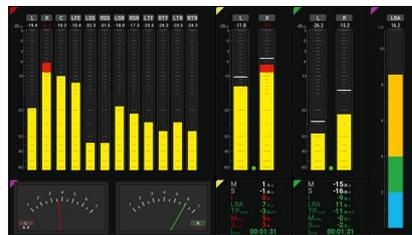
Diese Applikation stellt die bekannten RTW Premium Metering-Funktionen und Instrumente zur Verfügung: Multiformat-PPM, TP-Meter, Zeigerinstrumente (Moving Coil), Loudness-Messung und Berechnung, Darstellung der Loudness-Range und SPL-Darstellung und Summen-SPL-Wert-Berechnung. Bis zu 4 Instanzen sind möglich.
