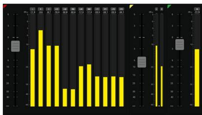
Diese Applikation dient zur unabhängigen Steuerung (Leveling) einzelner Kanäle oder Kanalgruppen mit bis zu 4 Fadern und einfachen TP-Metern, die zur relativen Pegelsteuerung mehrerer Kanal-Gruppen mit dem Drehknopf kombiniert werden können.
