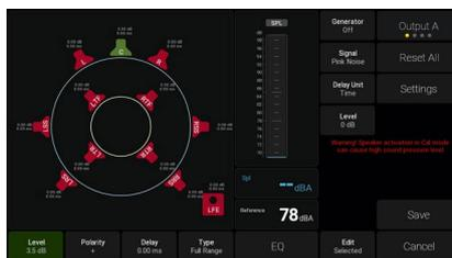
Die Lautsprecher im Setup können in Bezug auf Pegel, Verzögerung und EQ kalibriert werden. Die Unterstützung für Messmikrofone, der eingebaute Testtongenerator und das Live-Eingang-SPL-Meter bilden die Werkzeugkombination für die Kalibrierung der Lautsprecherpegel.
