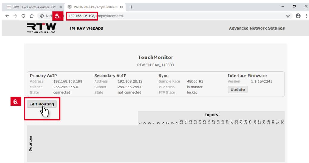
7. Weisen Sie durch Mausklick in die entsprechenden Felder die benötigten Quellen (**Sources**) den gewünschten Eingängen (**Inputs**) im TouchMonitor zu.
