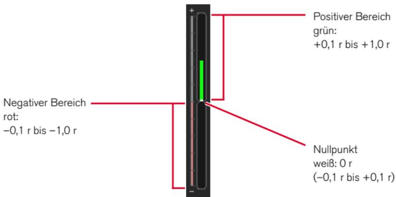
Der **Correlator** zeigt die Phasenbeziehungen zwischen den beiden Kanälen eines Stereosignals und damit seine Mono-Kompatibilität an. Identische Signale in beiden Kanälen haben die Korrelation +1, vollständig unabhängige Signale eine Korrelation von 0. Normale Stereomischungen zeigen meist Korrelationswerte zwischen 0,3 und 0,7 an. Wenn beide Kanäle identische Signale führen, die Polarität in einem der beiden Kanäle aber vertauscht ist (180° Phase), beträgt die Korrelation -1.
