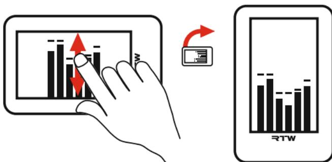
1. Wischen Sie im Normalbetrieb mit einem Finger vertikal über den Bildschirm des liegenden Gerätes. Die Anzeige wechselt von Querformat auf Hochformat.
