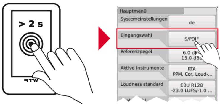
Die Auswahl des aktiven Signaleingangs für die aktuelle Messung erfolgt zwar initial durch die Abfrage nach der Domäne, kann aber durch Drücken und Halten des Bildschirms für mehr als 2 Sekunden jederzeit im Menü durch die Option **Eingangswahl** verändert werden. So ist es möglich, durch einfache Änderung der Eingangsdomäne elegant zwischen gleichzeitig angeschlossenen externen analogen und digitalen Signalquellen umzuschalten.
