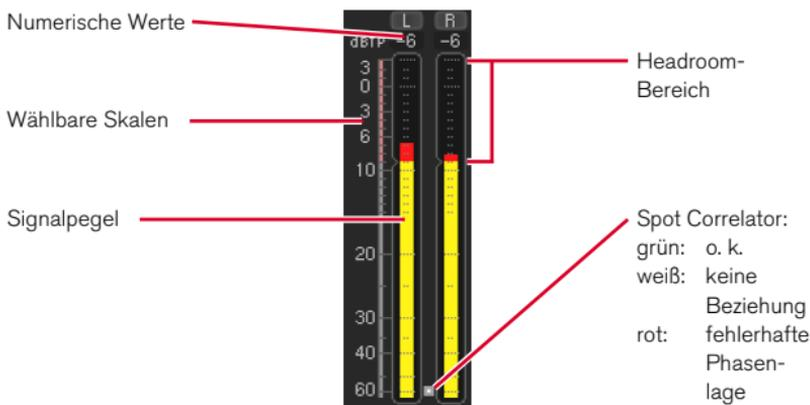
Das **TP/PPM-Bargraph**-Instrument bietet eine vertikale Bargraph-Anzeige für die Einzelkanäle der aktiven Signalquelle. Das Instrument zeigt pro Kanal den Signalpegel an. Überprüfen Sie anhand des TP/PPMs, ob die Pegel und Loudness-Werte der Einzelkanäle den für das gemessene Audioprogramm gültigen Vorgaben entsprechen.
