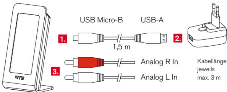
1. Stecken Sie den Micro-B-Stecker des mitgelieferten USB-Kabels in die USB Micro-B-Buchse des Gerätes.
