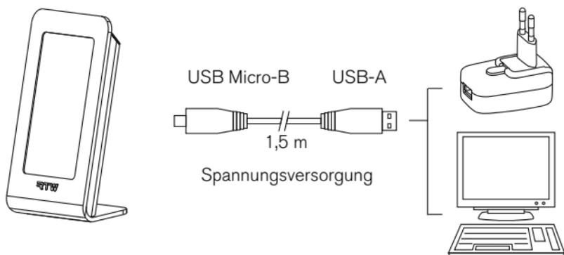
Die Spannungsversorgung erfolgt über den USB 2.0 Micro-B-Anschluss auf der Rückseite des Gerätes, entweder über das mitgelieferte externe USB-Netzteil oder direkt über einen PC. Verwenden Sie zur Verbindung das mitgelieferte USB-Kabel.
