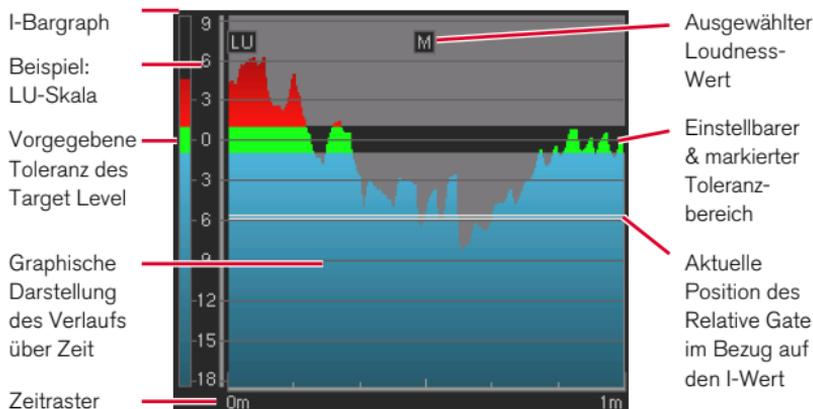
Das Loudness-**Chart**-Instrument zeichnet den Verlauf der Messung eines wählbaren Loudness-Wertes (TP-, M-, S- oder I-Wert über Zeit) als Linie oder farbige Fläche auf einem Koordinatensystem mit wählbarem Zeitraster. Zusätzlich kann im Graphen der Toleranzbereich als Korridor dargestellt werden. Eine dynamische Linie zur Anzeige der aktuellen Position des Relative Gates im Bezug auf den I-Wert und ein zusätzlicher Bargraph zur Anzeige des Integrated-Wertes kann eingeblendet werden.
