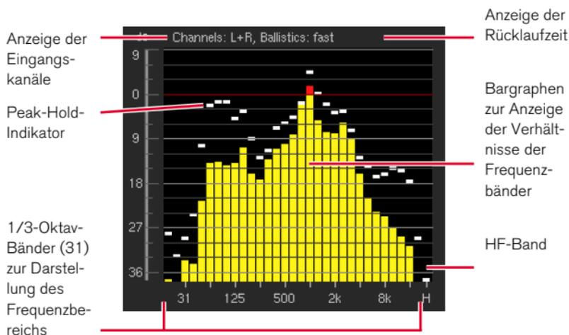
Das **RTA**-Instrument zeigt den spektralen Inhalt der Eingangskanäle mit 31 Filterbändern im 1/3-Oktavabstand an. Dabei werden die entsprechenden Pegelwerte in den Frequenzbändern dargestellt. Ein zusätzliches „H“-Band zeigt spektrale Signalkomponenten oberhalb von 20 kHz an. Der Nominalpunkt und die Skalierung der Anzeige kann so verändert werden, dass sie gut ablesbar im Anzeigefenster dargestellt wird. Die Pegelanzeige des RTA ist immer relativ.
