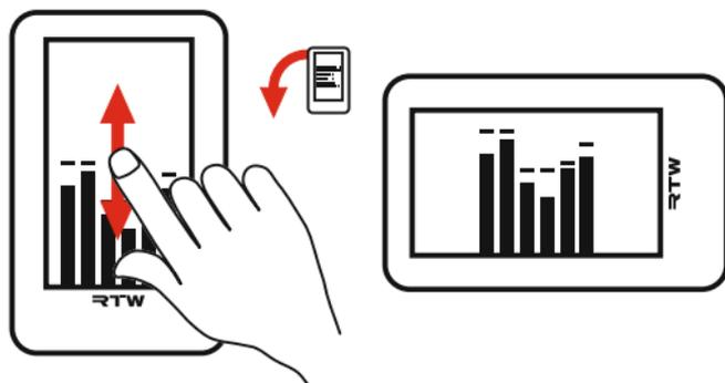
1. Wischen Sie im Normalbetrieb mit einem Finger vertikal über den Bildschirm des aufrecht stehenden Gerätes. Die Anzeige wechselt von Hochformat auf Querformat.
