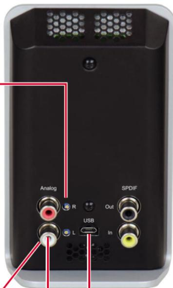
Signalleitungen mit RCA-Stecker (max. 3 m) müssen an der Verbindungsseite zum TM3-Primus bzw. TM3-Pri-2U mit einem Ferrit-Kern versehen sein.
