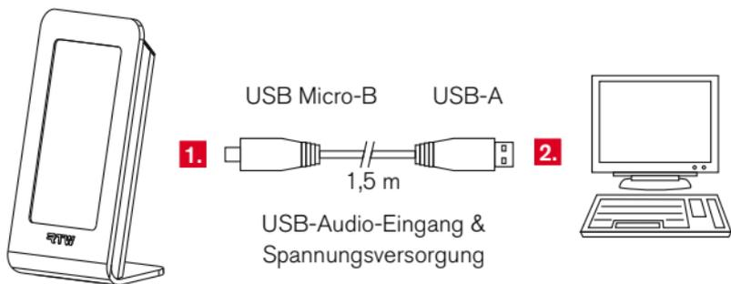
1. Stecken Sie den Micro-B-Stecker des mitgelieferten USB-Kabels in die USB Micro-B-Buchse des Gerätes.
