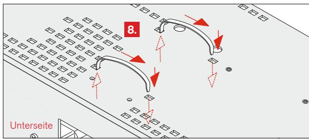
8. Führen Sie jeweils einen Kabelbinder von oben durch die zwei rechteckigen Öffnungen, die 6 cm von der glatten Rückseite der Interface-Box entfernt sind, von dort zu den direkt neben der Interface-Box liegenden rechteckigen Öffnungen (parallel zur Frontseite) und durch diese hindurch wieder nach oben.
