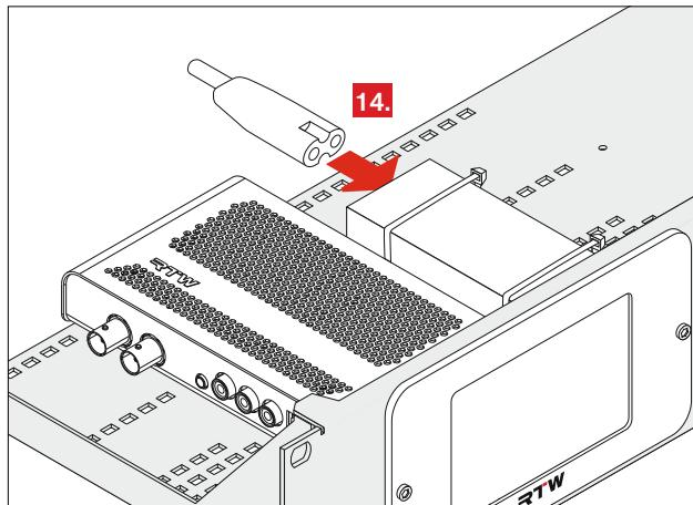
14. Schließen Sie erst dann das Netzkabel an das Netzteil aber noch nicht an das Stromnetz an.
