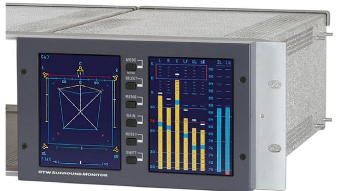
10860-VID mit 5.1 Surround-Peakmeter, SPL-Gesamtanzeige, Leq(A)-Anzeige sowie Surround Sound Analyzer (linkes Display) zur Balance-Überwachung von Surroundprogrammen.
