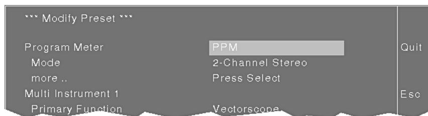
Bild D 5-3: Der angezeigte Modus im Menü „Modify Preset“, wenn der PPM-Modus gewählt ist
