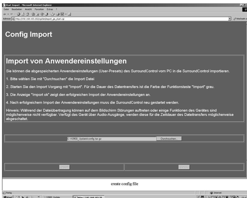
Bild 5-22: Die Anwendereinstellungen werden importiert
