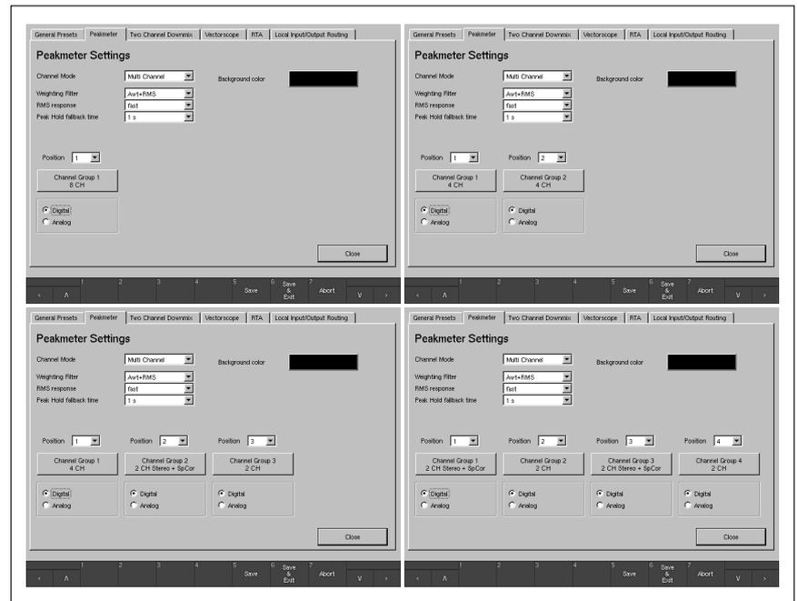
Bild 4-38: Menüseite „Peakmeter“ mit unterschiedlicher Anzahl Kanalgruppen („Channel Group“) im „Multi Channel“-Modus
