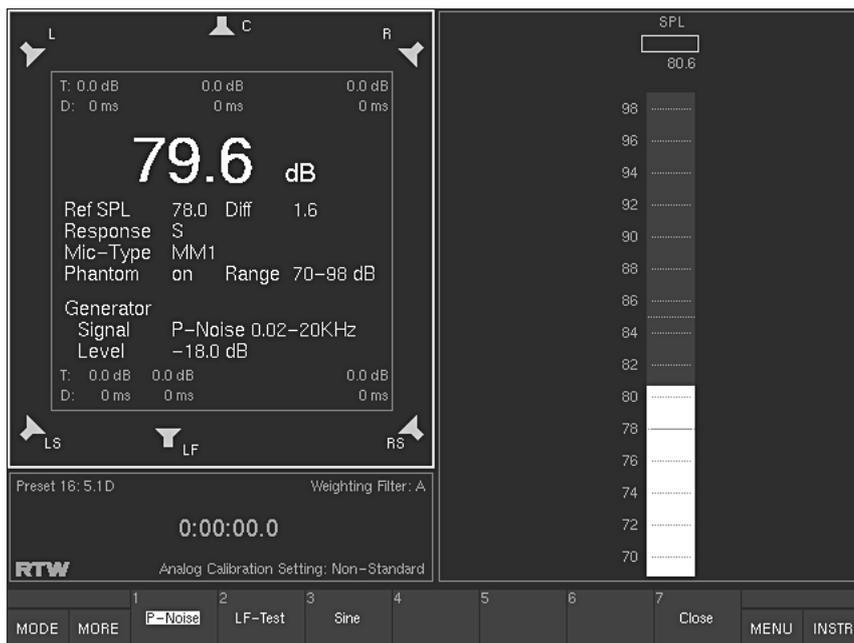
Bild 3-16: Bildschirmanzeige nach Aufrufen der Funktion „Signal Select“ im Instrument CAL.
